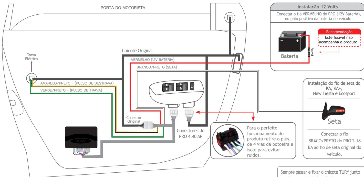
As cores dos fios originais e suas funções e localizações podem variar. Com um multímetro sempre verifique antes de instalar nossos produtos, para evitar possíveis problemas. A TURY não se responsabiliza por danos causados no sistema elétrico do veículo por falhas de instalação.
